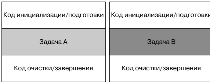
Рис. 3.2. Задачи А и В окружены стереотипным кодом подготовки/очистки
